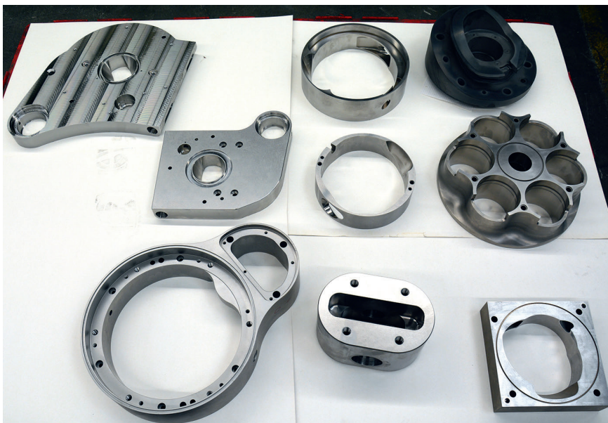
4 Kleine Auswahl in Stahl: Ein Teil des Bauteilsortiments, das Frey auf seinem Grob-5-Achs-BAZ G550 mit Palettenautomation fertigt © Hanser
